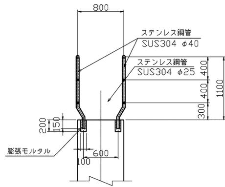
空気弁詳細図 S=1:15
