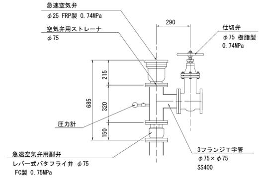
空気弁用ストレーナ詳細図
