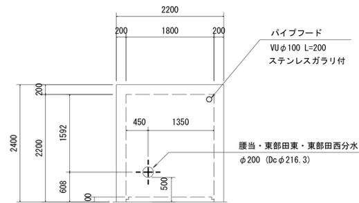
弁室外面図(左岸側面)
