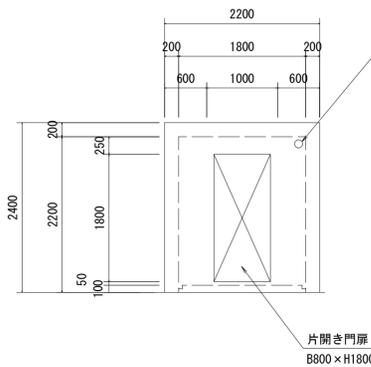
弁室外面図(下流面)
