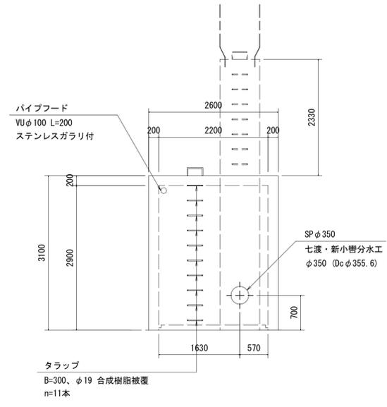
弁室外面図(下流面)
