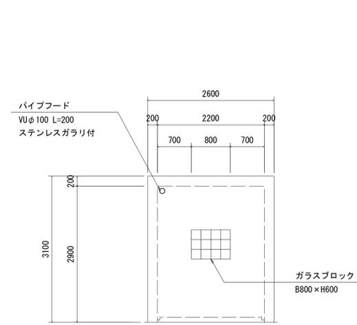
弁室外面図(左岸側面)
