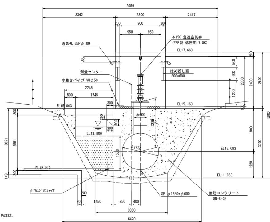
注: 空気弁の3FT字管及び仕切弁の取付平面角度は、平断面図の角度とする。
