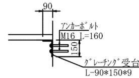
水抜工詳細図 S=1:20
