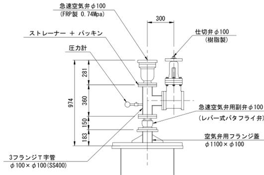
ストレーナー断面図 S=1:10 (SUS304製)
