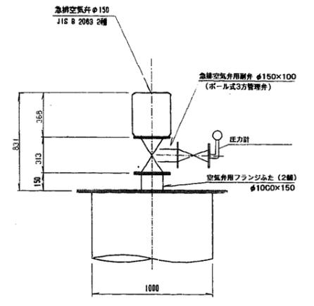
※圧力計は空気弁2基の片側のみ
