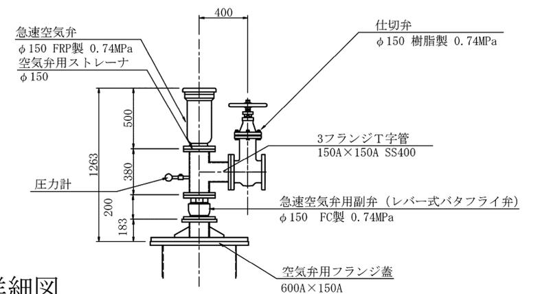
空気弁用ストレーナ詳細図
